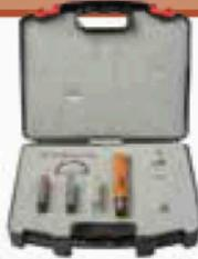
Bu çanta, Amerikan Adalet Bakanlığının metal dedektörleri test etme amaçlı olarak oluşturduğu Test Kiti demosudur. İçinde 3 büyüklükte – değişik metal nesnelere olup; Kimisi silahlı simule etmekte, kimisi de daha küçük ve en küçük tehdit objelerini simule etmektedir. Aynı test çantasında zararsız metal objeler de simule edilmiş olup, onların geçişinde alarm verilmesi istenmemektedir.
